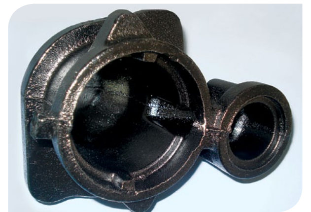
Slika 4: Z omakanjem pobarvan odlitek
